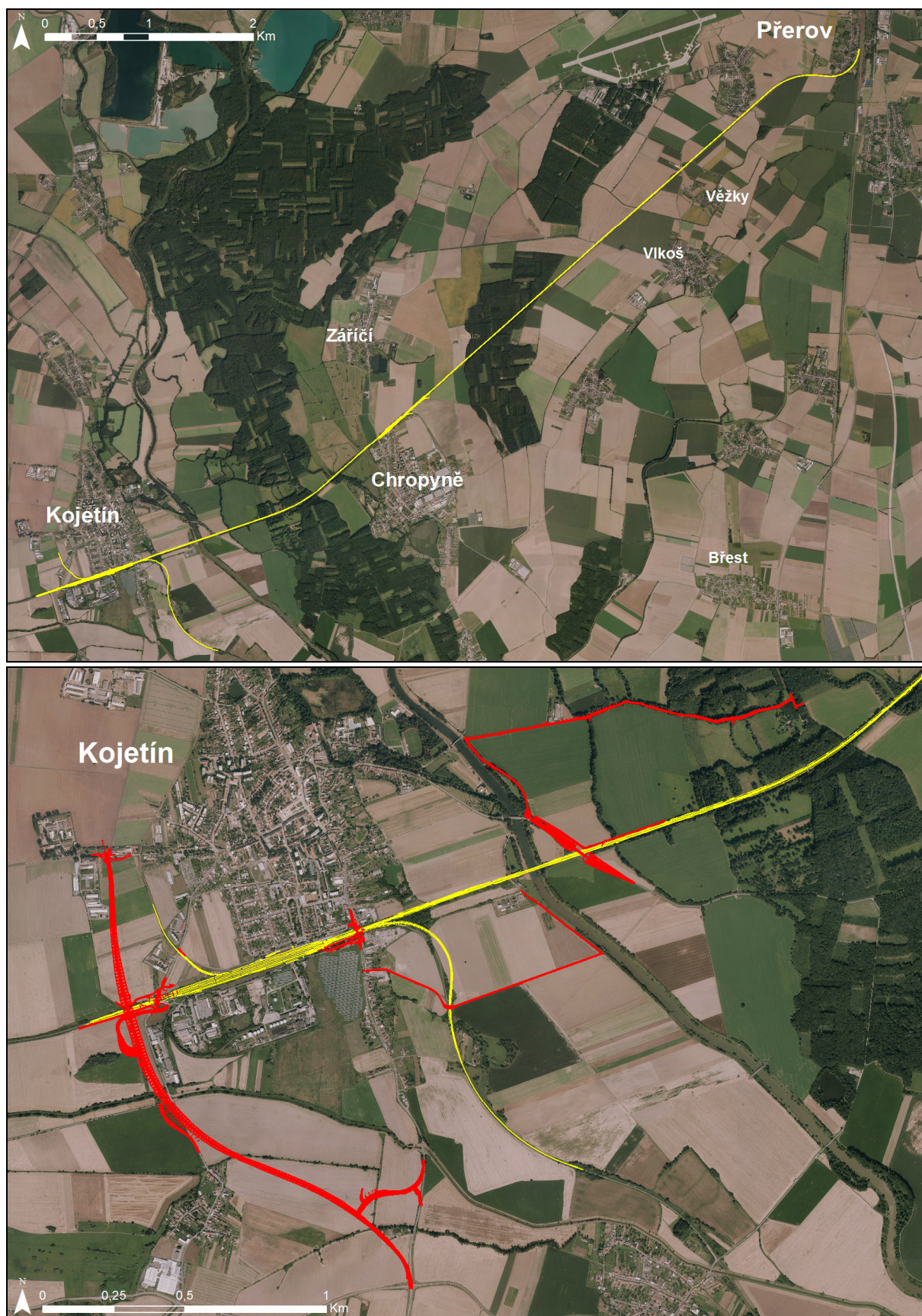
Obr. 1: Celková situace záměru – žlutě je vyznačeno nové trasování železnice, červeně obchvat Kojetína a úpravy stávajících cest
