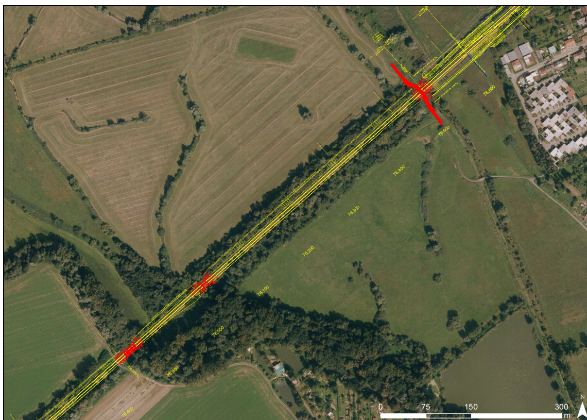
Obr. 14: Migrační profil podél Malé Bečvy, bezejmenného toku a Svodnice, navržená železnice je vyznačena žlutě, mostní objekty a úpravy komunikací červeně
