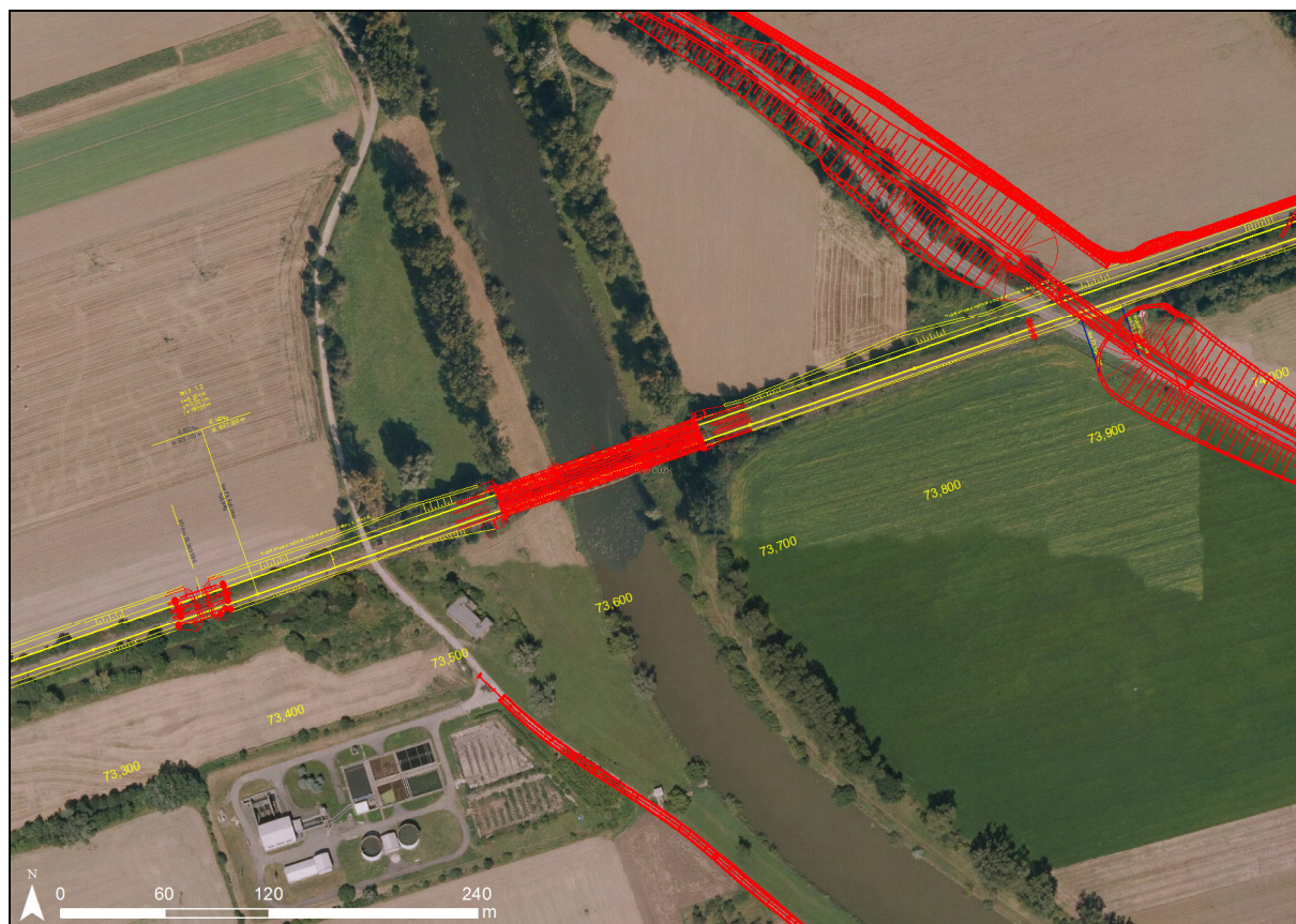
Obr. 8: Migrační profil podél řeky Moravy, navržená trať je vyznačena žlutě, mostní objekty a úpravy komunikací červeně
